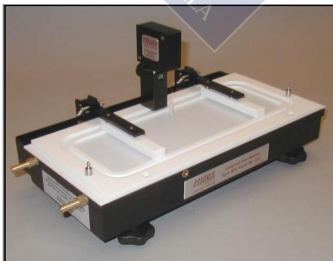
**Ilustración 1.4.B.-** Ejemplo de balanza superficial de Langmuir.
