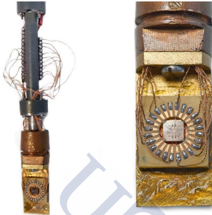
Figura 3.5. Imagen derecha: detalle del portamuestras intermedio pegado con grasa Apiezon N sobre la placa de cobre del portamuestras de medida. Por la parte posterior de la placa se pega el termómetro Pt-100. Imagen izquierda: imagen del cableado procedente del portamuestras intermedio que se suelda a los contactos situados a ambos lados de la estructura plástica
