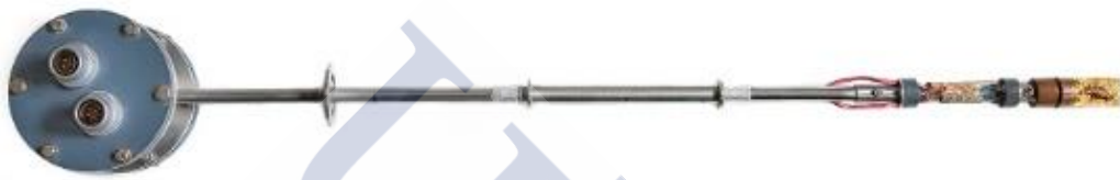
Figura 3.4. Imagen del portamuestras de medida. En el extremo derecho se sitúa el portamuestras intermedio y en la parte izquierda el cabezal de contactos BNC.
