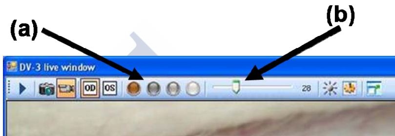
Figura 39. Imagen del control de iluminación del software Topcon IMAGEnet i-base. (a) 4 niveles discretos de iluminación. (b) Barra del nivel de iluminación que indica 28 unidades (Iluminación 2).
