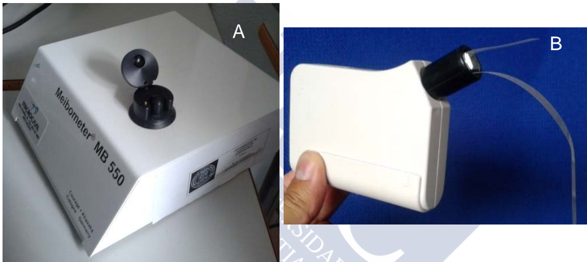
Figura 24. Meibómetro MB550. A) Unidad de medición que el la parte superior tiene la unidad fotométrica. B) Cassette que contiene la cinta de medición.
