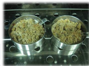
Figura 152. Determinación do contido de humidade.
