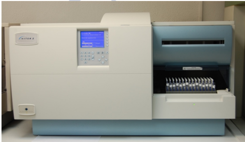
Figura 5. Equipo de incubación y lectura del sistema VITEK 2.
