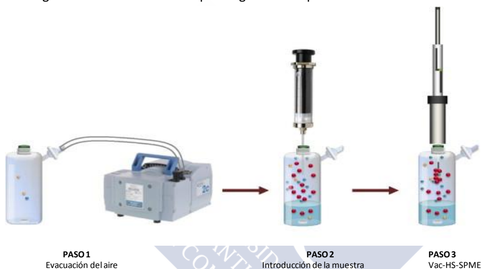
Figura IV.8. Esquema del procedimiento de extracción mediante Vac-HS-SPME
