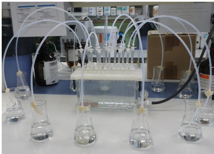
Figura 2.5.1. Montaje experimental requerido para realizar la SPE.
