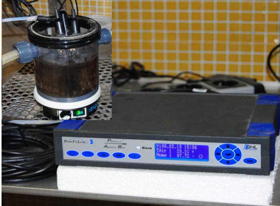
Figura 14: Sistema Profilux 3 nos permite monitorizar el pH, la conductividad, temperatura y humedad en la fase líquida. Los sensores están sumergidos en el Tanque de Mezcla y Control (arriba a la izquierda).
