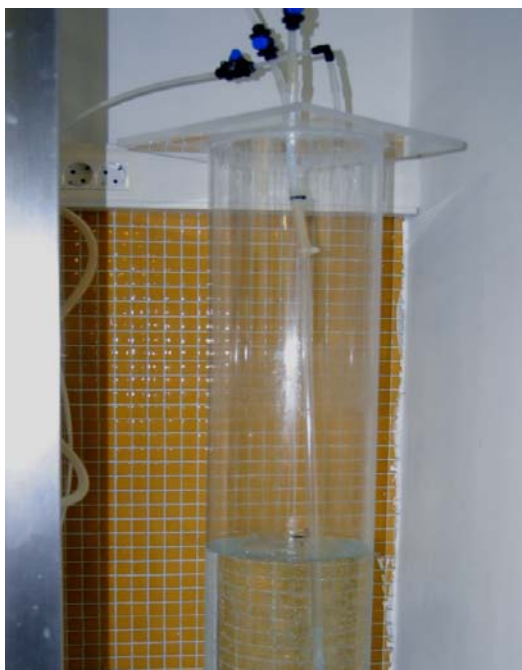
Figura 12: Columna humidificadora por la que se hace pasar el aire para que se sature.
