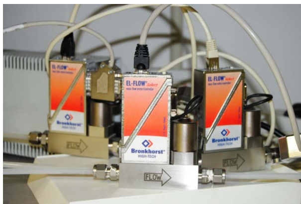
Figura 13: Caudalímetros máscicos EL-FLOW. Cada uno de ellos controla la corriente de un gas. En este caso hay uno para el aire, otro para el metano y otro se ha instalado para la incorporación del N 2 O.
