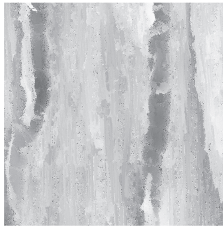
Figura 4. Imagen topográfica de la superficie de uno de los campos analizados por CLSM de la cara exterior de una chapa de ayous.
