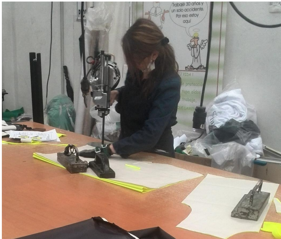
Figura 13 Proceso de Corte, Confecciones Taller 84
