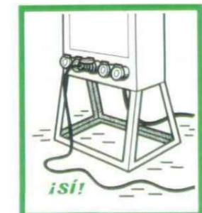
Hay que proteger al máximo las canalizaciones eléctricas contra los riesgos de aplastamiento, cizalladura, cortes, etc... Debe remplazarse todo cable estropeado..
