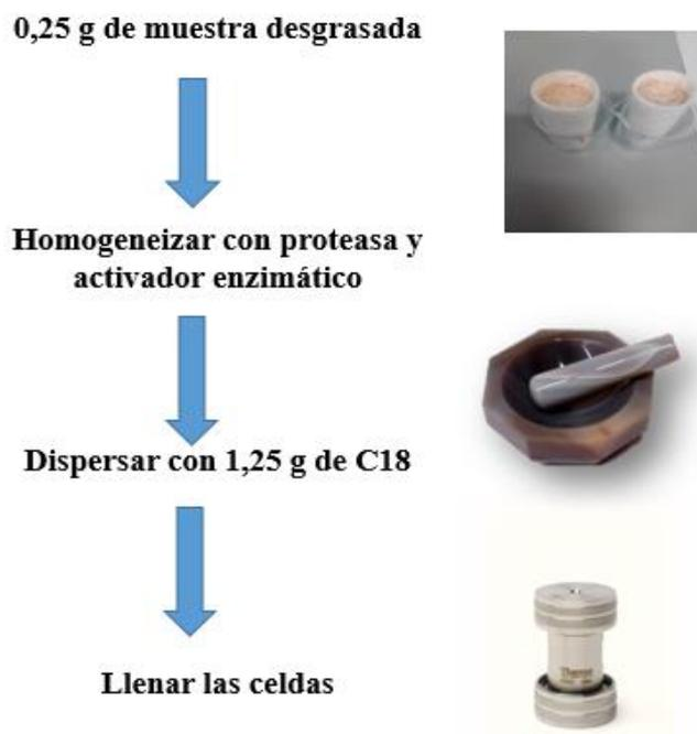
**FIGURA 9.-** Esquema del procedimiento de llenado de celdas del Dionex ASE-200.
