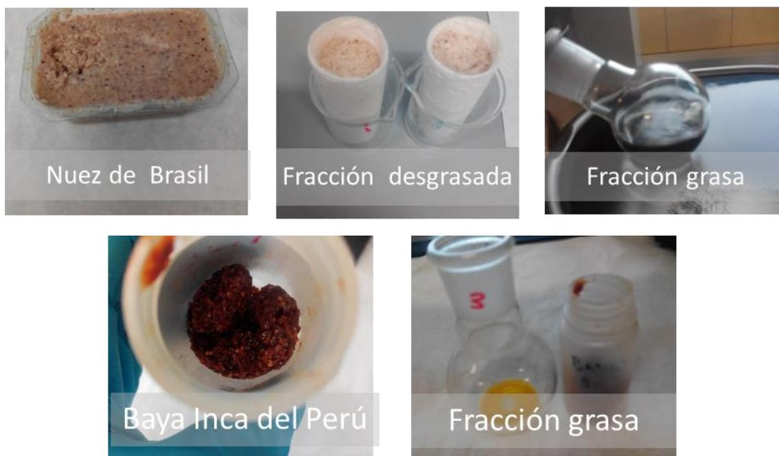
**FIGURA 8.-** (A) Muestra de nuez de Brasil, fracción desgrasada y fracción grasa obtenida tras extracción Soxhlet. (B) Muestra de Baya inca del Perú y su fracción grasa obtenida tras extracción Soxhlet.
