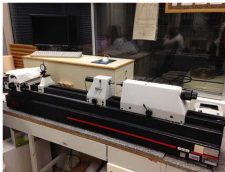
Figura 1: Mahr 828 antes de su reparación en el laboratorio acreditado.
