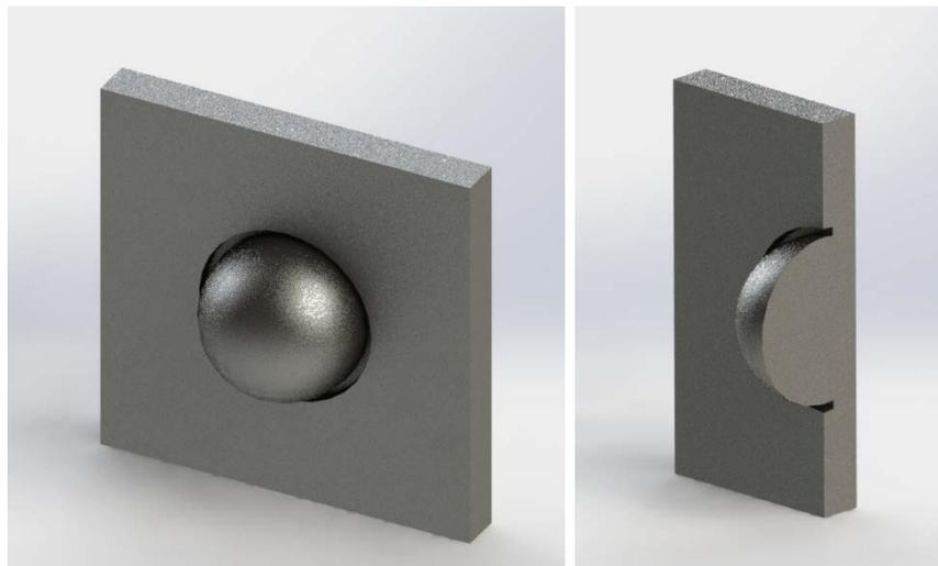
Ilustración 37. Parte 1 molde tapa esfera
