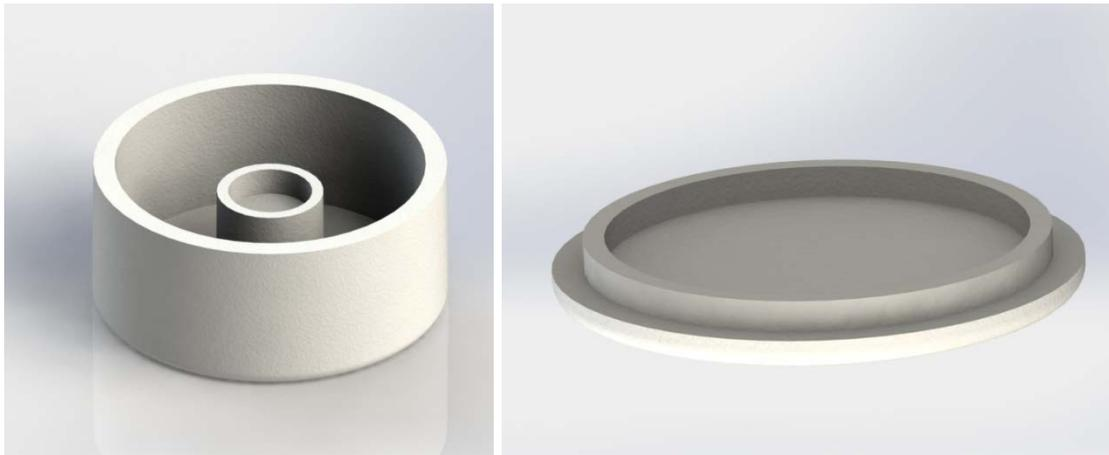
Ilustración 98. Cuerpo y tapa del cilindro
