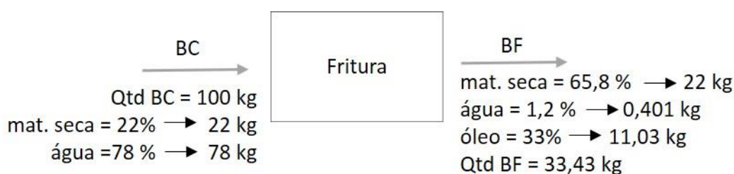
Figura 15 – Representação esquemática do balanço de massa com indicação das composições da batata e das quantidades envolvidas.
