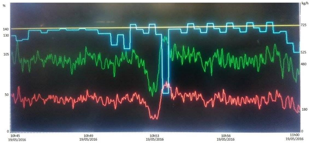
Figura 59 - Período das 10h45-11h00 de análise das bolas de BF ondulada sal. Legenda: --- velocidade do sem fim (%) ; --- altura da camada (mm) ; --- consumo de BF (kg/h) ; --- pedido BF (kg/h) .
