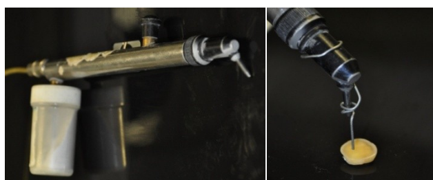
Figura 21 – Jato Airsonic Mini Sandblaster (Hager & Werken, Duisburg, Germany) (esq.) com um arame ortodôntico a 10 mm de distância do dente (dirt.).
