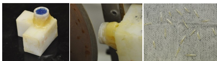
Figura 28 – Corte dos palitos com uma secção transversal de 1\pm 0,2 mm 2 . Apenas os palitos marcados com a área correspondente à dentina foram aproveitados.
