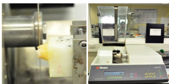
Figura 16 – Exposição da dentina média com recurso ao micrótom de tecidos duros Accutom-50 (Struers A/S, Ballerup, Denmark) (dirt.).
