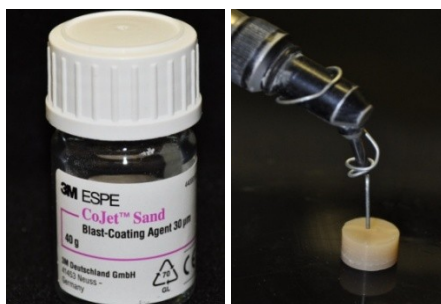
Figura 22 – Tratamento de superfície dos discos de resina composta, utilizando partículas de óxido de alumínio silicizadas CoJet™ Sand (3M ESPE).
