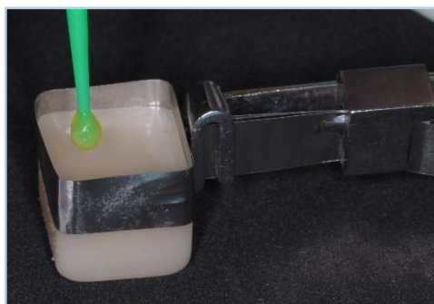
Figura 27 – Aplicação do Scotchbond™ Universal
