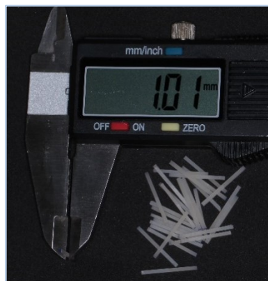
Figura 38 – Medição das dimensões de cada microbarra com uma craveira digital
