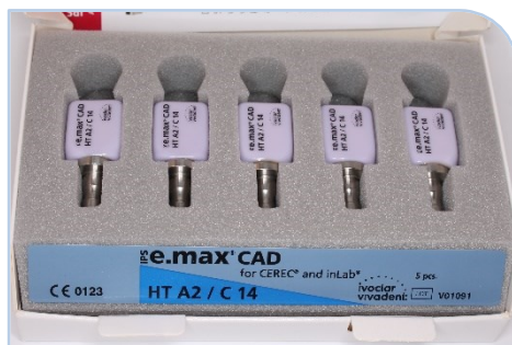
Figura 6 – Blocos de cerâmica e.max ® CAD (Ivoclar Vivadent) no estado pré-cristalino
