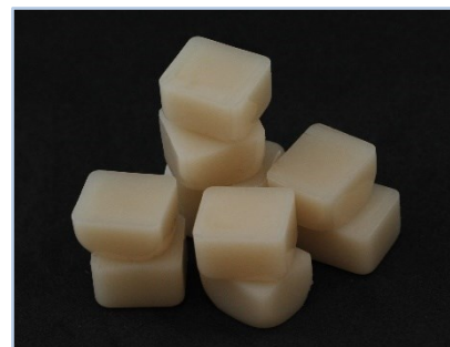
Figura 7 – Amostras ( n=10 ) de cerâmica e.max ® CAD (Ivoclar Vivadent) após sinterização e corte dos blocos
