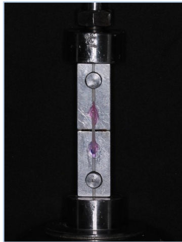
Figura 40 – Microbarra fixa a um jig de aço inoxidável de Geraldeli
