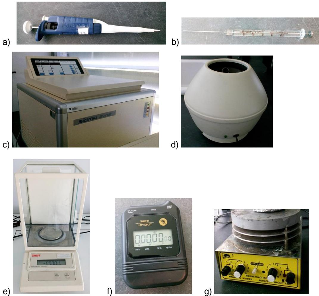
**Figura 2.3** – Materiais e equipamentos usados: a) Micropipeta automática de precisão (Nahita, Modelo 6600 series, 50µL); b) Seringa volumétrica graduada (Hamilton, Modelo Gastight #1705, 50µL); c) Centrífuga (Sigma, Modelo 2K15); d) Centrífuga de mesa (J.P. Selecta, Modelo Angular); e) Balança analítica de precisão com 4 casas decimais (OHAUS, Modelo AS120); f) Cronómetro e g) Agitador magnético (SBS, Modelo A06).
