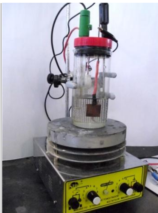
Figura 3.1 – Aspectos fotográficos da célula eletroquímica em que se podem ver, em primeiro plano, os elétrodos de trabalho, de referência e auxiliar, bem como o sensor de temperatura utilizados para a deposição do revestimento de NiOOH sobre o substrato de aço AISI 304.
