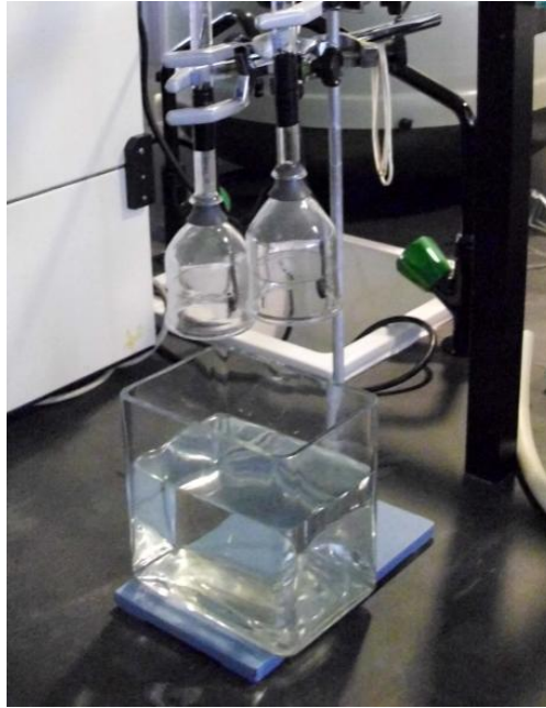
Figura 3.4 – Tina e buretas invertidas para a produção e recolha de H_2 e O_2 obtidos durante a eletrólise em solução aquosa de NaHO a 1 M.
