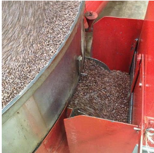
Saída de café pelo despredador (eliminação de partículas estranhas pela presença de ímanes).
