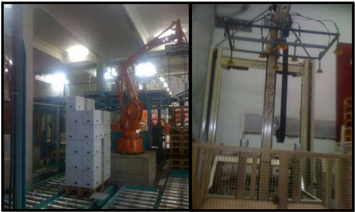
Figura 42: Robôs que efetuam a paletização das massas alimentícias (à esquerda) e paletização do esparguete (à direita).
