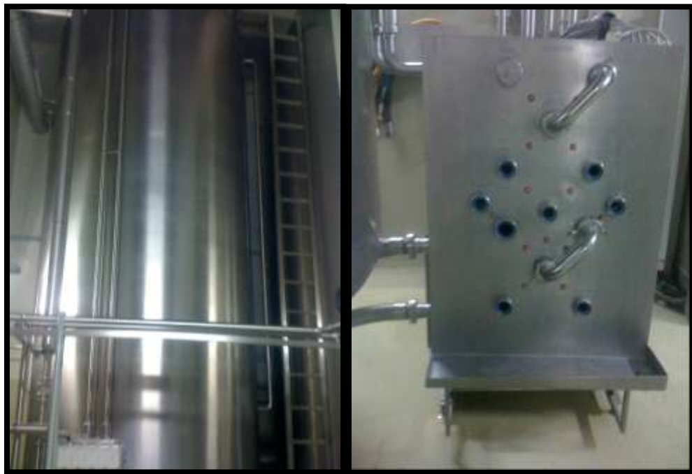
Figura 60: Tanque de armazenagem de ovo líquido pasteurizado e quadro sistema de limpeza CIP.
