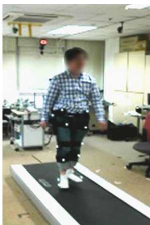
Fig. 2.9 – Análise cinemática da marcha de um indivíduo através do sistema utilizado em (Yun et al , 2013)
