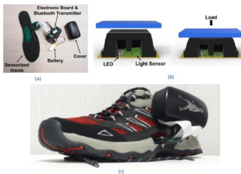
Fig. 2.4 – Sistema do estudo (Crea et al , 2014): (a) Constituintes do sistema, (b) funcionamento da unidade de transdução, (c) sistema montado no sapato
