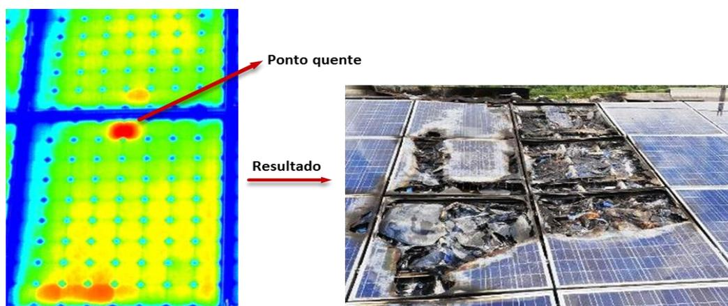
**Figura 2- 17:**Efeito de aquecimento excessivo (“Hotspot”).
