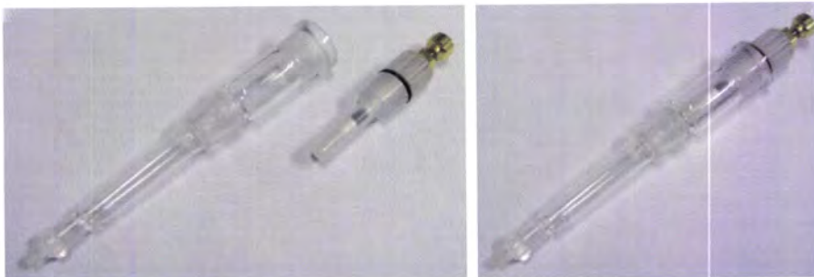
Figura 13 - Conjunto de eléctrodo de referência e ponte salina, desmontado e montado.
