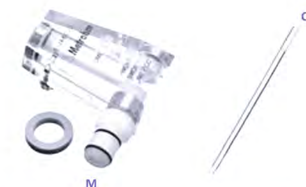
Figura 15 - Multi-Mode Electrode (MME) (à esquerda) e capilar de vidro (à direita). A parte C do capilar é introduzida na parte M, do MME.
