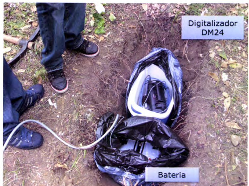
Figura 5.1: Estação utilizada como referência durante o teste. Em cima, foram feitos dois furos: um para o sensor e outro para o digitalizador e a bateria. A imagem em baixo mostra disposição da bateria e do digitalizador.
