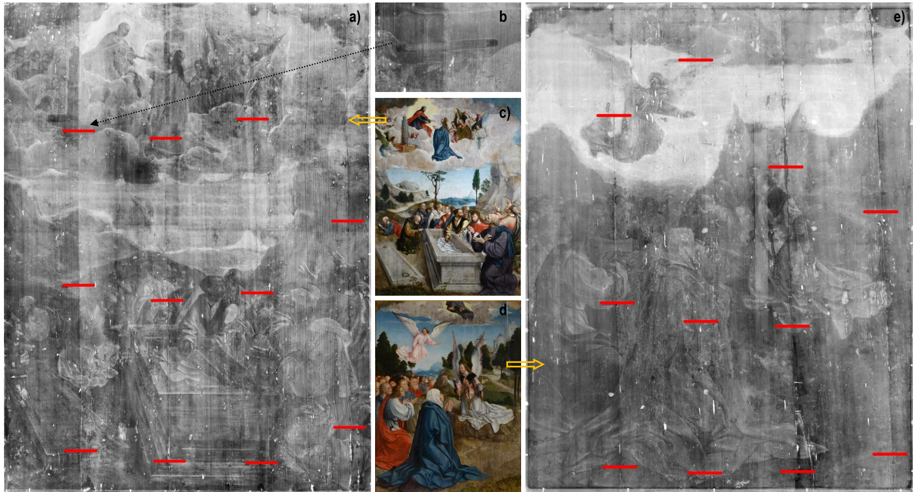
Figura 4-8 - Localização dos elementos de ensablagem (originais) nos painéis representando a Assunção da Virgem (163 x 121 cm) e a Ascensão de Cristo (154 x 121 cm): a) e e) radiografias de raios X com localização das cavilhas (a vermelho), b) imagem de pormenor de uma cavilha, obtido por radiografia de raios X, c) e d) fotografias gerais dos painéis (luz visível). CF 2
