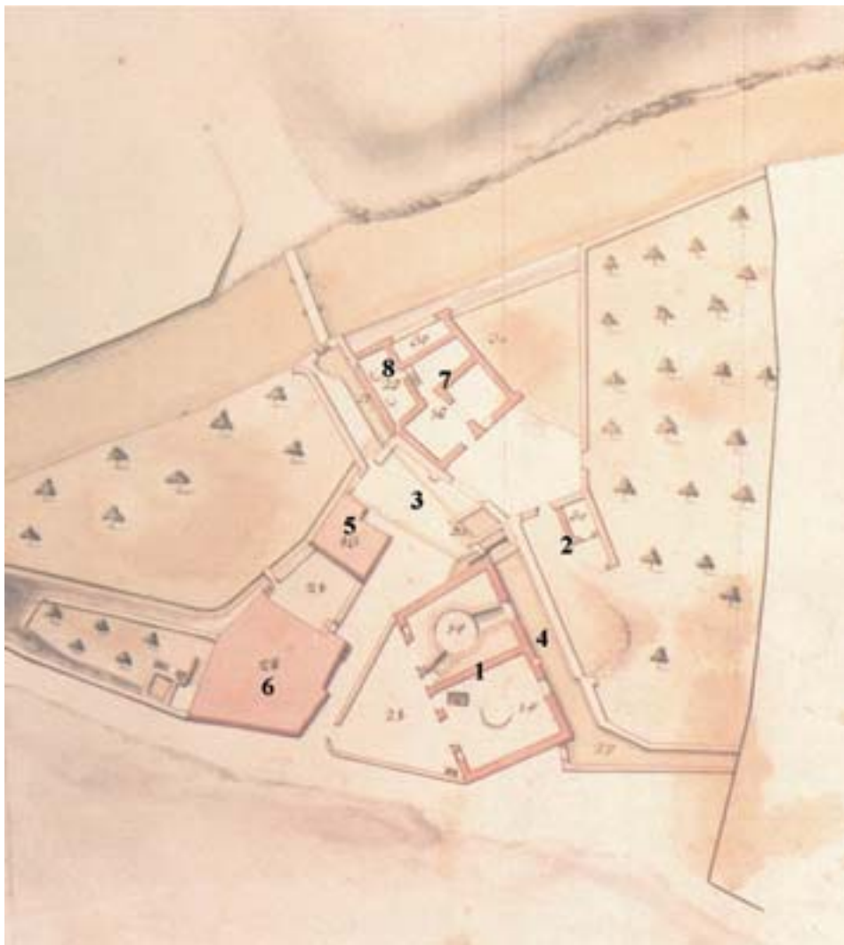
Fig. 18 – Proposta de identificação dos diferentes espaços integrantes do conjunto edificado correspondente às Ferrarias del Rey , com base na planta de 1775 e no conteúdo do inventário de 28 de Dezembro de 1685 ( Apêndice Documental , Doc. 102): 1 - Edifício das forjas; 2 - Casa de verrumar; 3 - Casa de limar; 4 - Canal sobre a galeria das rodas hidráulicas; 5 - Casa «em que dormiam os moços»; 6 - Casa do mestre coronheiro; 7 - Casa do superintendente; 8 - Azenha com duas moendas.
