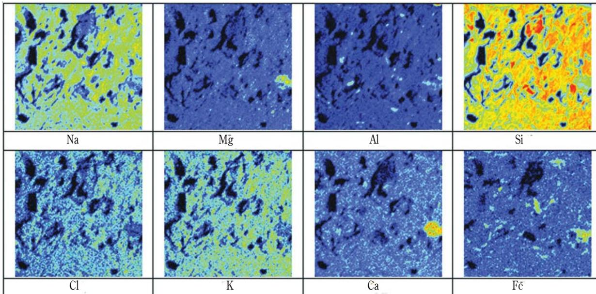
**Fig. 9** – Mapas da distribuição elemental de Na, Mg, Al, Si, Cl, K, Ca e Fe, numa área da amostra com 3,7x3,7 mm<sup>2</sup>, mostrando também a superfície irregular e a presença de grãos com Mg, Fe e Ca.
