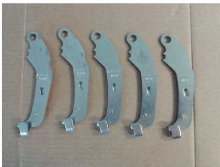
(a) Irregularidades no aspeto de peças utilizadas no caso de estudo (face 1).
