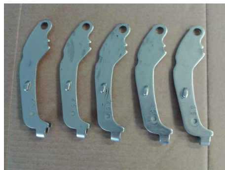
(b) Irregularidades no aspeto de peças utilizadas no caso de estudo (face 2).
