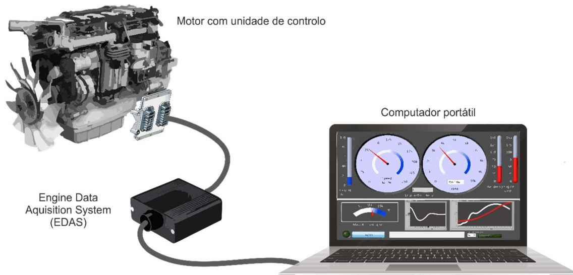
Figura 4.1 - Esquema de ligação do interface EDAS.
