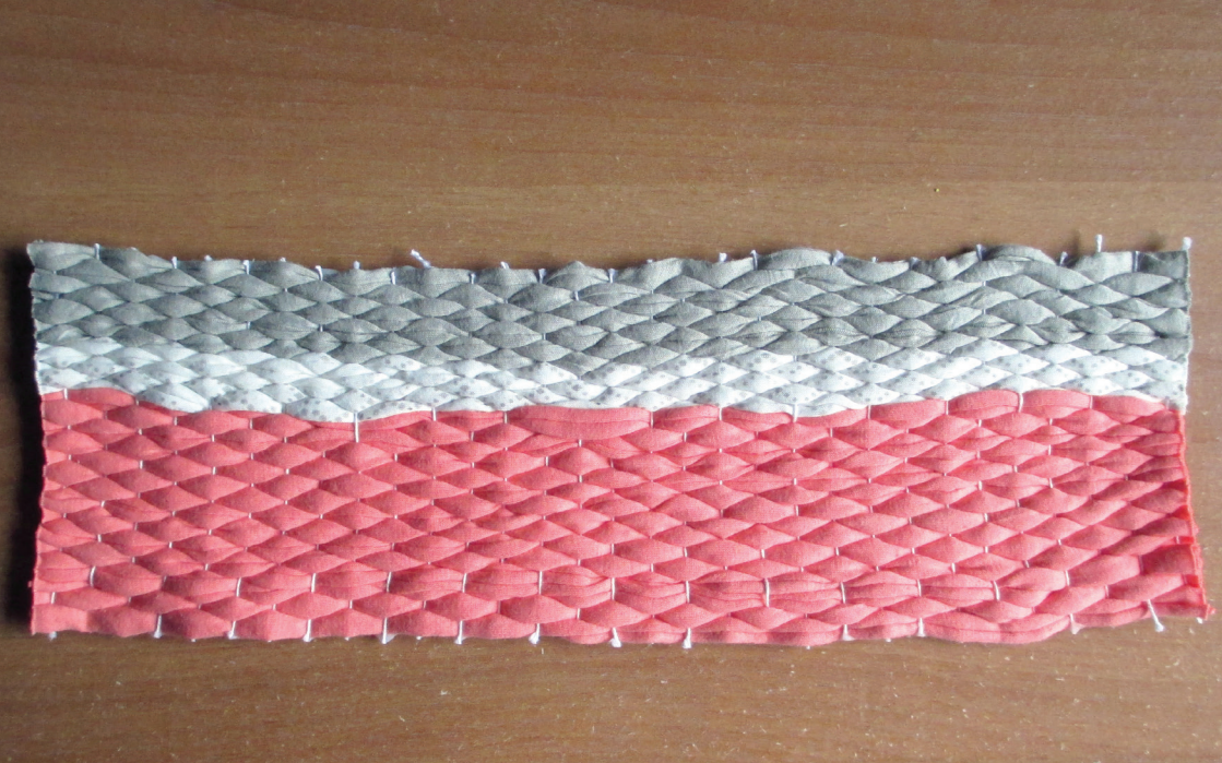
Fig. 58, 59, 60, 61. Experiências de corte e resistência do material depois de colado
