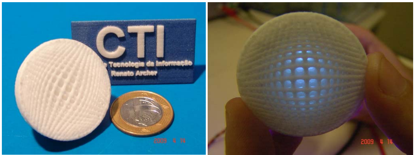
Figure 7. Model fabricated in polyamide material using a 3D Systems Sinterstation HiQ at the Centro de Tecnologia da Informação, Brasil.
