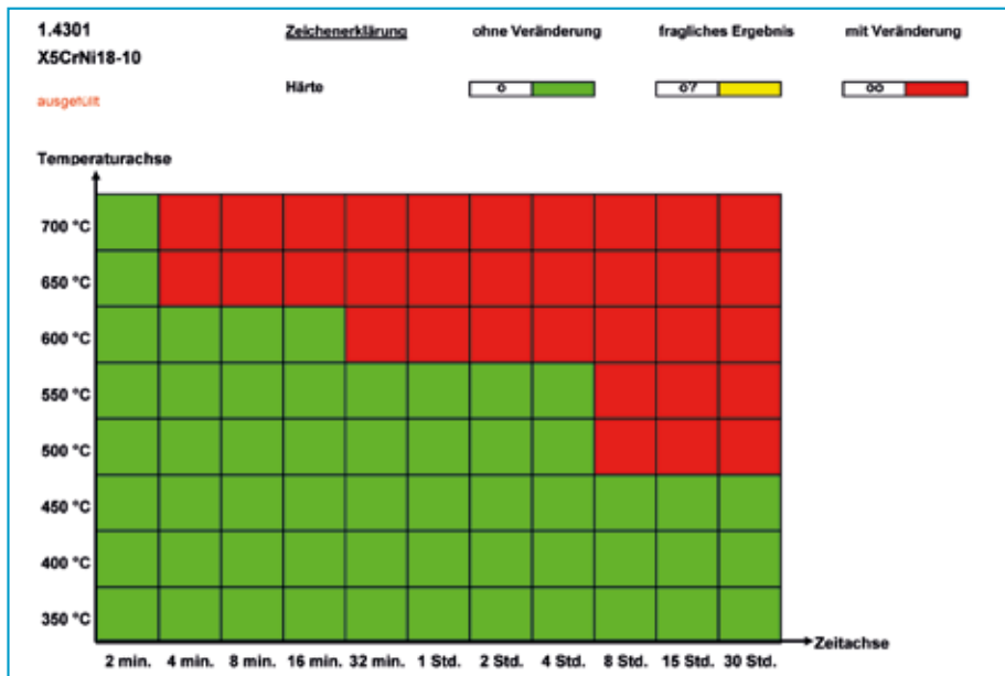
ABB. 8: Härteveränderung in Abhängigkeit von der thermischen Auslagerung bei X5CrNi18-10 (1.4301) im kolsterisierten Zustand.
