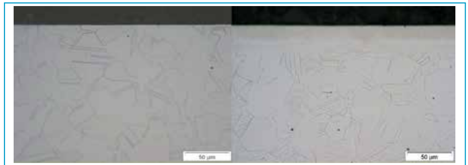
ABB. 2: Beispiel für die Gefügeausbildung eines austenitischen Nichtrostenden Stahles, hier der Werkstoff X5CrNi8-10 (1.4301) vor (linkes Teilbild) und nach dem Kolsterisieren (rechtes Teilbild).
