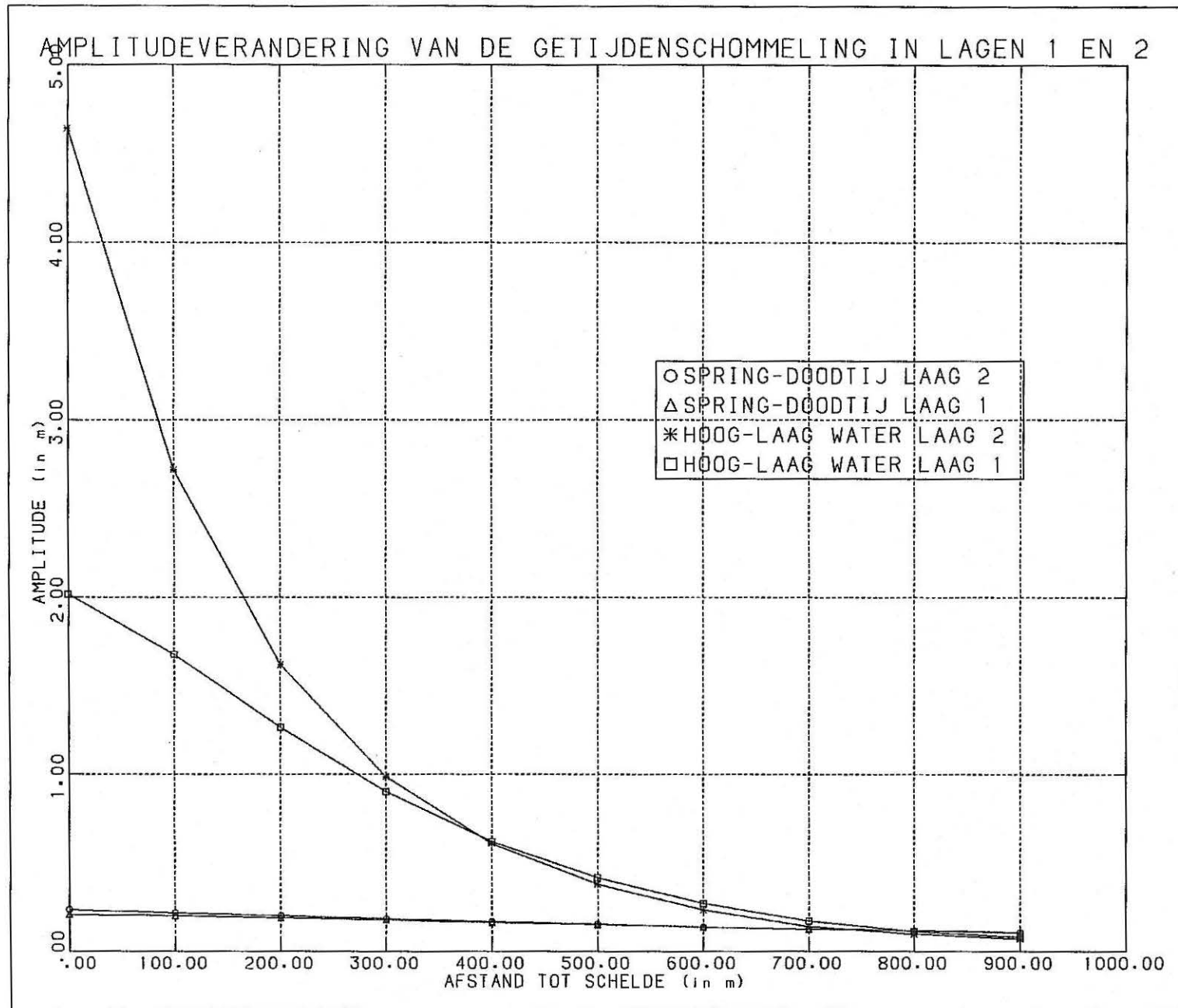
Fig. 4.22 Berekende amplitudeverandering van de getijdenschommeling in lagen W1 en W2
