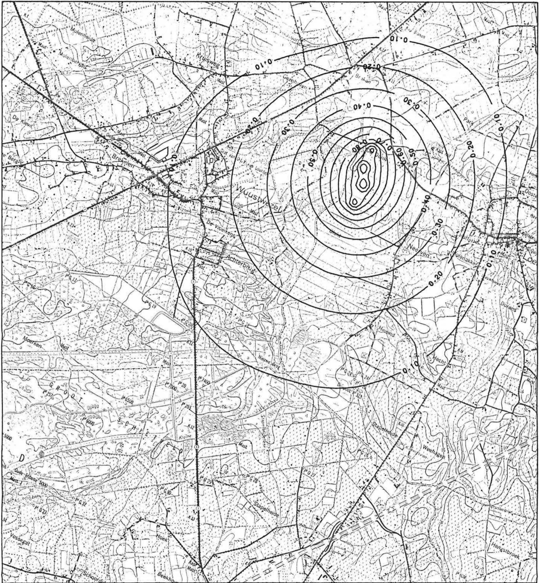
PLAAT 7: BW=10000 NW=5000 M3/DAG: VERLAGING IN LAAG 1
