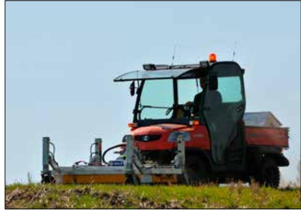
Abb. 4: Das motorisierte Bodenradarsystem Mira II im Einsatz (Foto: LBI ArchPro, Geert Verhoeven).
