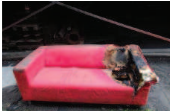
Figuur 3: Opstelling brandexperimenten VIPA (links), verbrande tweezitsbank na experiment met RWA en sprinkler (rechts).
