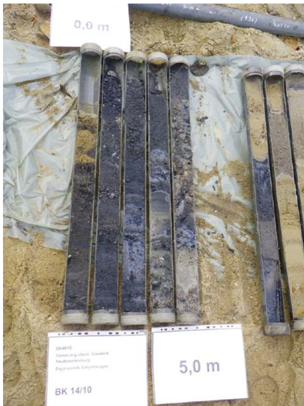
Abb. 3: kontaminierte Bodenproben (Bohrkerne)
