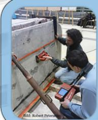
Mit einem Bewehrungsscanner kann die Bewehrung im Beton geortet und deren Verlauf verfolgt, der Stabdurchmesser des verwendeten Stahls ermittelt und die Betondeckung bestimmt werden.
