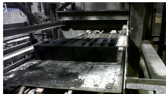
Figure 3. SUS-CON panels production in Magnetti facility / Produzione pannelli SUS-CON presso Magnetti.
