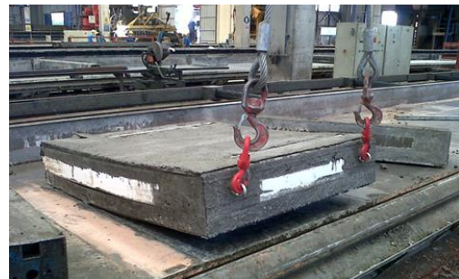
Figure 3. SUS-CON panels production in Magnetti facility / Produzione pannelli SUS-CON presso Magnetti.
