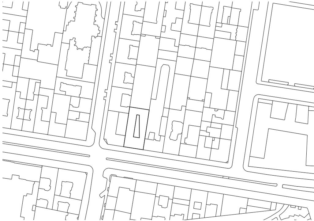
„Die Kubatur knüpft an die umliegenden Bestandsgebäude an, indem sie die Höhen aufnimmt. In den kompakten Baukörper, der die Baulücke schließt, ist ein Atrium eingeschnitten, das die Belichtungssituation optimiert und die Kommunikation im Inneren ermöglicht.“
