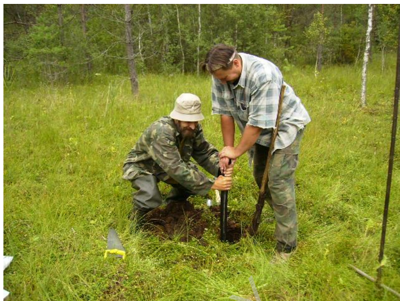
Фота 2.4. Устаноўка гідралагічнага калодзежа на балотным участку ў даліне р. Котра
