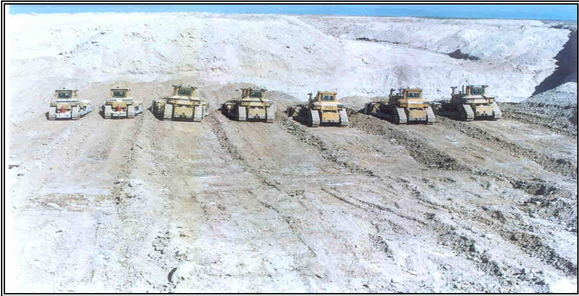
Fig.39: Il decapaggio della superficie da rimuovere. Fonte: Direction des Exploitations Minières de Khouribga-Division Gestion Administrative et Sociale, MNK/AK/S, Rapport de stage, Aprile 2010, p.14
