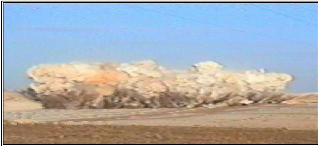
Fig.38: La detonazione del giacimento attraverso esplosivo. Fonte: Direction des Exploitations Minières de Khouribga-Division Gestion Administrative et Sociale, MNK/AK/S, Rapport de stage, Aprile 2010, p.14
