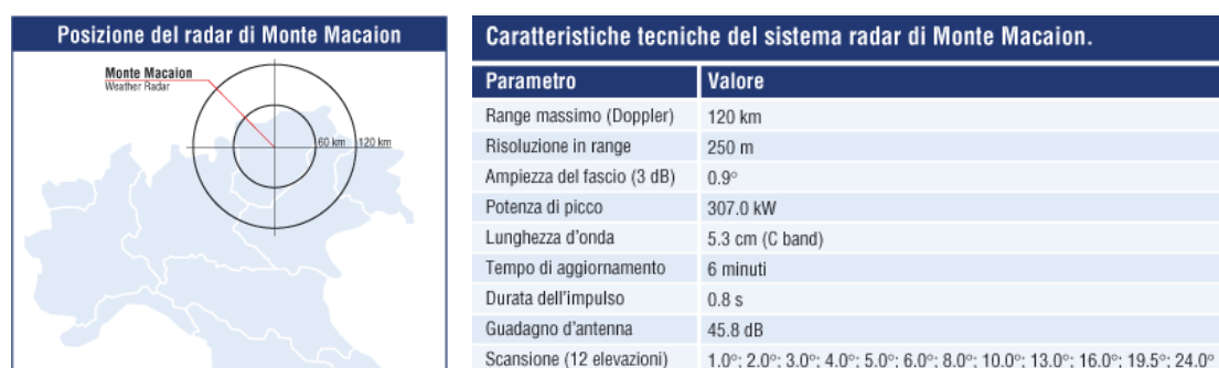
Figura 3.17: Posizione e caratteristiche tecniche del radar di Monte Macaion (da Borga et alii, 2004a)
