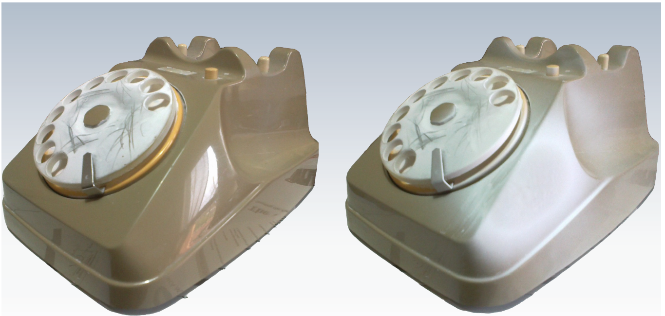
4.09_ (A sinistra) Foto della scocca dell'S62 prima dell'utilizzo dello spray opacizzante. (A destra) Foto dell'oggetto dopo il trattamento effettuato con lo spray opacizzante. Vediamo come il trattamento rende le superfici meno sensibili all'illuminazione contestuale.
