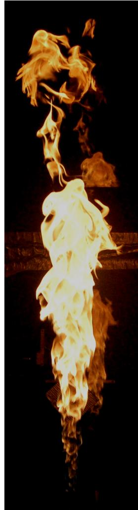
FIGURE 1.4. Turbulent Diffusion Flame
