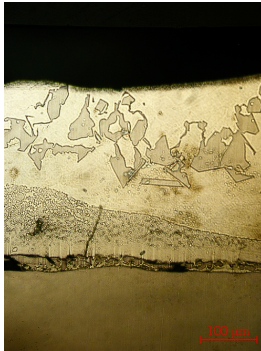
Figura 96 Propagazione di una cricca nella fase \delta in direzione ortogonale all'interfaccia e arresto nella fase \eta ; energia assorbita 4 J
