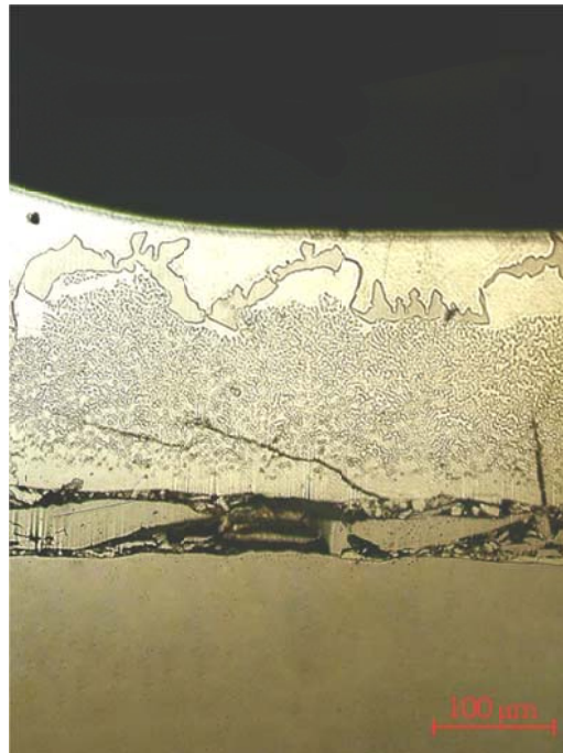
Figura 97 Propagazione obliqua delle cricche all'interno della fase \delta ; energia assorbita 4 J
