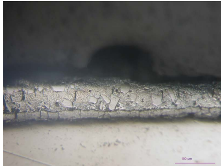
Figura 104 Micrografia a 200x dell'apice dell'impronta dalla parte tesa del provino
