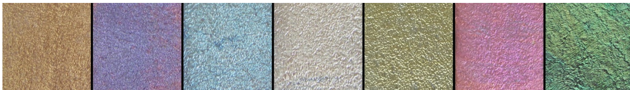
Figura 123 Colori ottenuti con la lega di zincatura con lo 0.2% di titanio in peso
