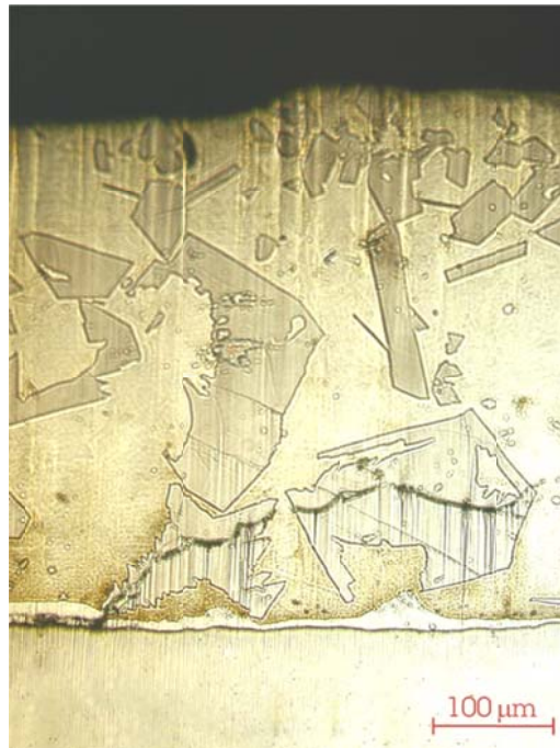
Figura 98 Formazione delle cricche all'interno della fase tau; energia assorbita 4 J.
