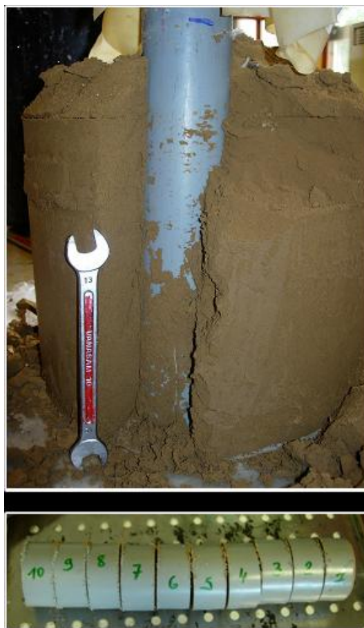
Figura 6.45. Particolare del tubo infisso per la determinazione di w e \gamma_d
