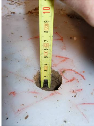
Figura 6.42. Profondità di infissione della fondazione
