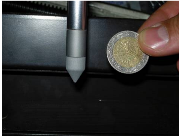
Figura 6.1. Penetrometro utilizzato per le prove CPT
