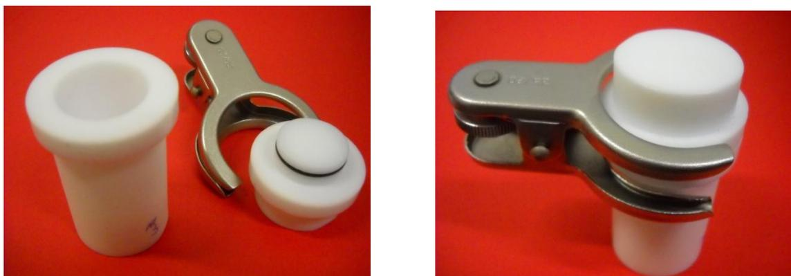
Figura 3.18: Camera in teflon opportunamente realizzata per l'esposizione di campioni di NIST 1648 ad atmosfere controllate di  $\text{NH}_3$ .
