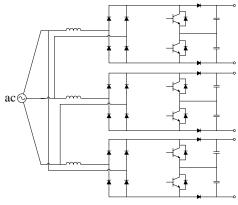
Fig. 2.2: Phase-modular delta rectifier
