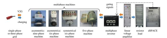
Fig. A1: Experimental rig.
