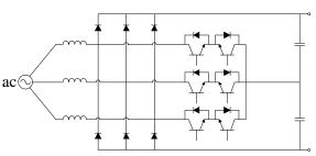
Fig. 2.5: Delta-switch rectifier.
